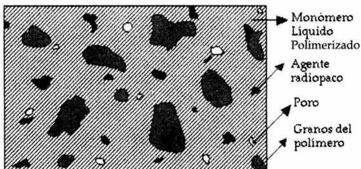
**Figura No. 2** Representación esquemática de la estructura interna de los cementos óseos.
