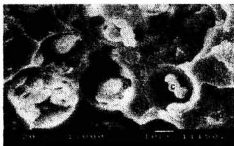
**Figura No.50** Estructura interna del cemento óseo acrílico modificado con Jibia. Probeta fracturada de tracción.
