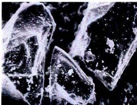
Figura 5 .Los composites de macrorrelleno e híbridos contienen partículas de cuarzo molido, como las que se muestran aquí (diámetro 0.1 – 20 \mu\text{m} ).
