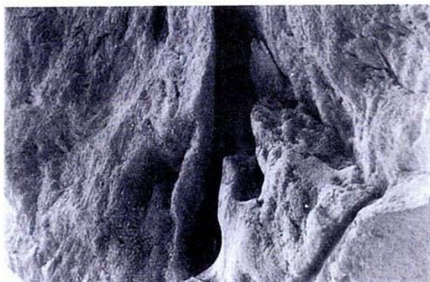
Figura 28. Fisura en "Y" invertida. Incidencia 7%
