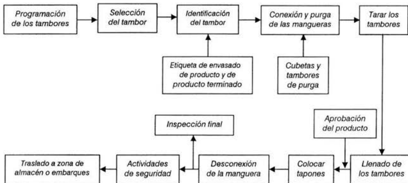
Figura 2.4 Diagrama del llenado de tambores
