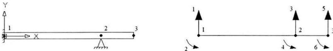
Figura 2.8 Ensamble de dos elementos viga
