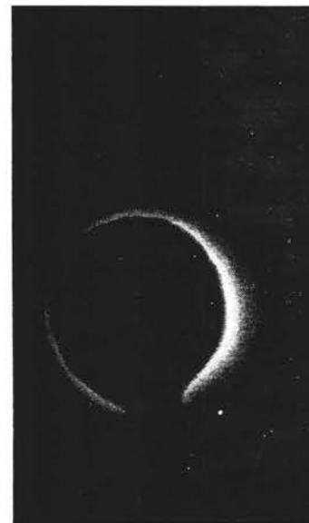
Defecto del recubrimiento en la fase elastómerica
