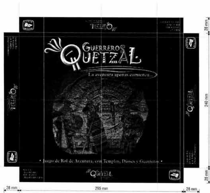
Desarrollo geométrico con cotas del envase y retícula base que justifica el diseño.
