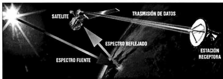
Figura 2 - 1 (Esquema operativo de un satélite de observación) [8]
