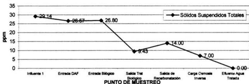
**Figura 10.** Comportamiento de la concentración de Sólidos Suspendedos Totales en el tren de tratamiento
