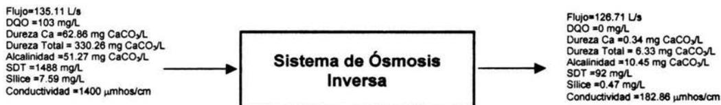
**Figura 11.** Balance de materia en el sistema de ósmosis inversa
