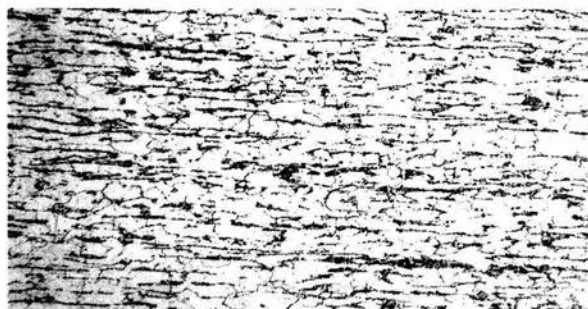
Fig. 4.9 Corte longitudinal del material de llegada. Se observan los granos de ferrita alargados y perlita bandeada debido al laminado en frío (300X)
