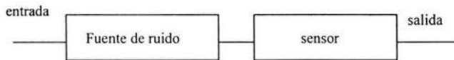
Fig. 2.3 Diagrama de bloques de un sensor con su respectiva fuente de ruido.
