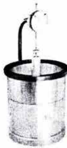
Figura 13. Dispositivo para medir la expansión en muestra de material para capa de pavimento.
