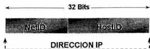
Fig. 1.7 Dirección IP dividido en dos partes, la de red y la de host.
