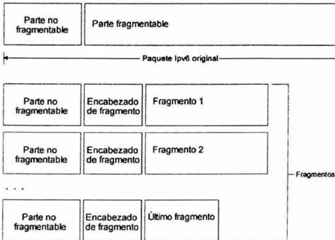
Figura 2.5 Proceso de fragmentación de IPv6
