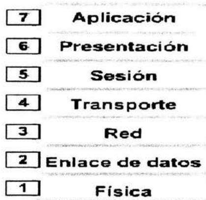
Fig. 1.11 Capas del modelo OSI
