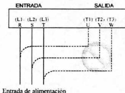
Figura 4.2 Conexión de la alimentación L1,L2 y L3
