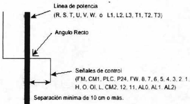
Figura 4.7 Separación entre líneas de potencia y control
