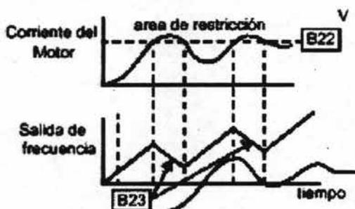
Figura 3.21 Grafica de restricción de sobrecarga
