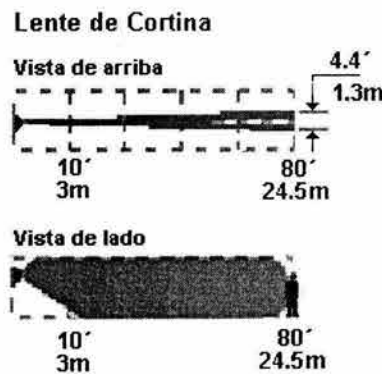
Figura 1.40 Patrón de detección del sensor infrarrojo con un lente de cortina.
