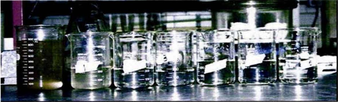
Foto A3.13 Agua residual cruda (extremo izquierdo) y agua después del tratamiento con el reactivo de Fenton
