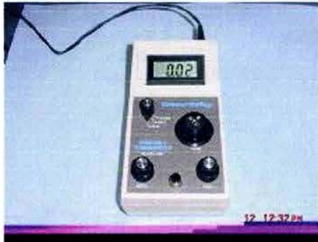
**Foto A3.7. Turbidímetro Orbeco-Hellige 966. Calibrado y ajustado a cero desde su fabricación, maneja 3 escalas: 0-20, 0-200 y 0-1000 UTN**
