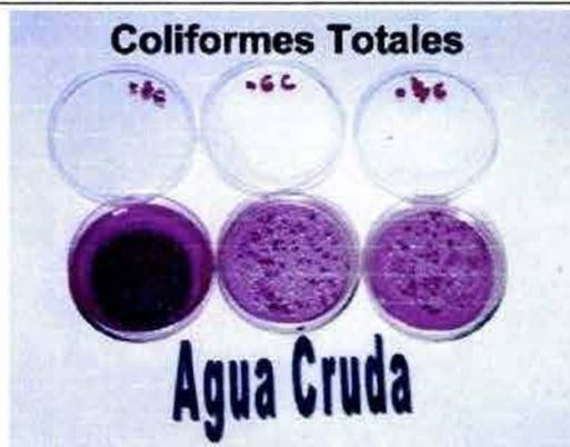
Foto A3.15 Pruebas microbiológicas realizadas para determinar y cuantificar las UFC de coliformes totales presentes en el agua residual cruda. Se puede observar la gran cantidad de microorganismos coliformes totales presentes los cuales son utilizados como indicadores de contaminación patógena.
