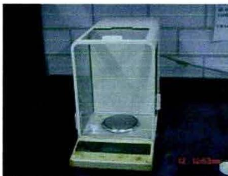
**Foto A3.2. Balanza analítica OHAUS. Se empleó para pesar los reactivos utilizados con gran precisión**
