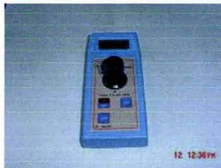
**Foto A3.6. Colorímetro de ion específico HANNA HI93727. Maneja un rango de 0 a 500 unidades Pt-Co**
