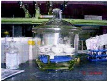
**Foto A3.9. Desecador. Empleado para la determinación de los sólidos suspendidos totales y para secar el sulfato de hierro que se utiliza en la elaboración del reactivo de Fenton**
