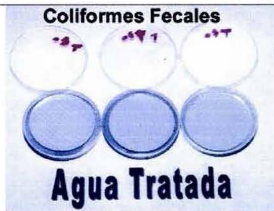
Foto A3.24 Pruebas microbiológicas realizadas para determinar la presencia de UFC de coliformes fecales en el agua tratada con el reactivo de Fenton. Es notable la eliminación del 100% de este tipo de microorganismos.
