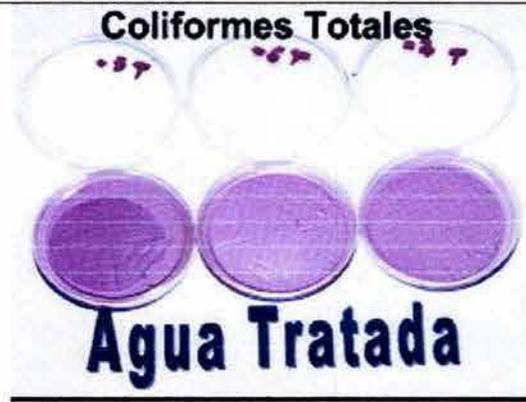
Foto A3.16 Pruebas microbiológicas realizadas para determinar la cantidad de coliformes totales presentes en el agua tratada con el reactivo de Fenton. Se observa la nula presencia de estos microorganismos.
