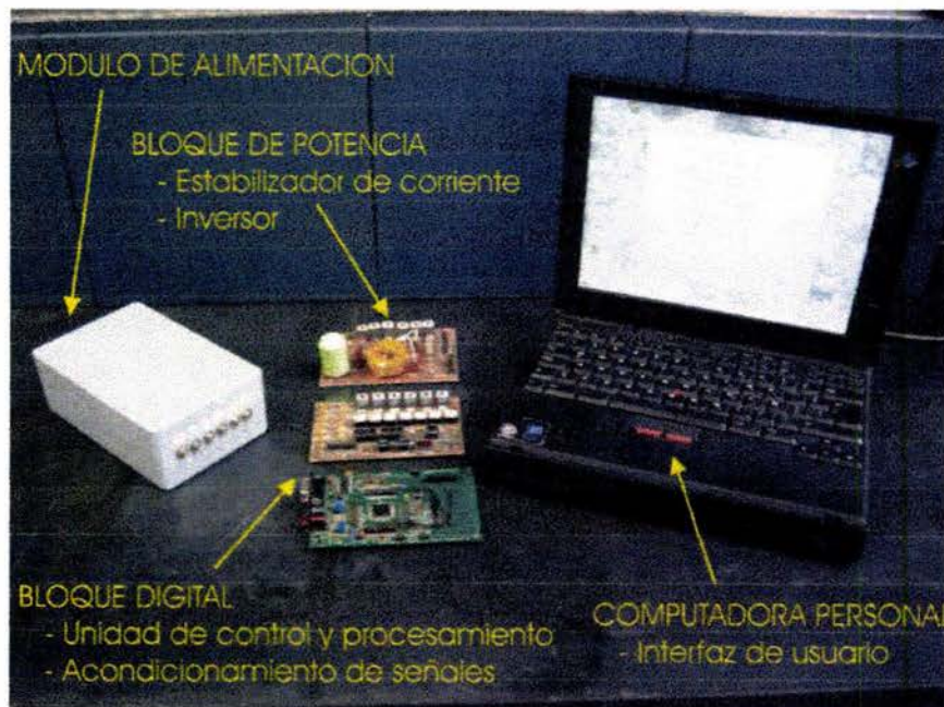
Figura 3-1. Módulos funcionales del generador multifuncional programable
