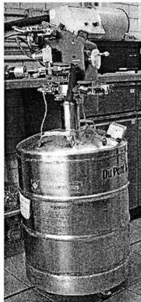
Figura 5.4 Accesorio para refrigeración de nitrógeno líquido
