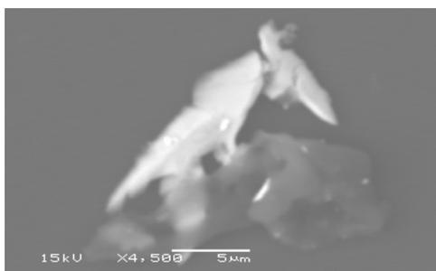
**Figura 4.8** Imagen por MEB del material formado a partir de  $[FtFeCN]_n$  y sal de potasio del 1,8-dihidroxi-antraquinona.
