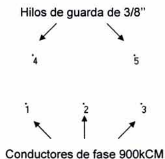
Figura 8.9 Disposición de conductores simulados en estructuras para la línea de 230 kV.
