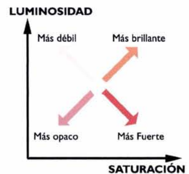
Fig. 3.6 Coordenadas de color comúnmente usadas en las industrias textil y de la pintura.
