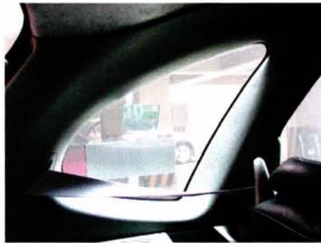
Fig. 10. 2 En la foto de arriba, se ve la franja pintada de negro sobre el vidrio, oculta por el marco interior y que contribuye a mejorar la apariencia del vehículo por la gran superficie de cristal.
