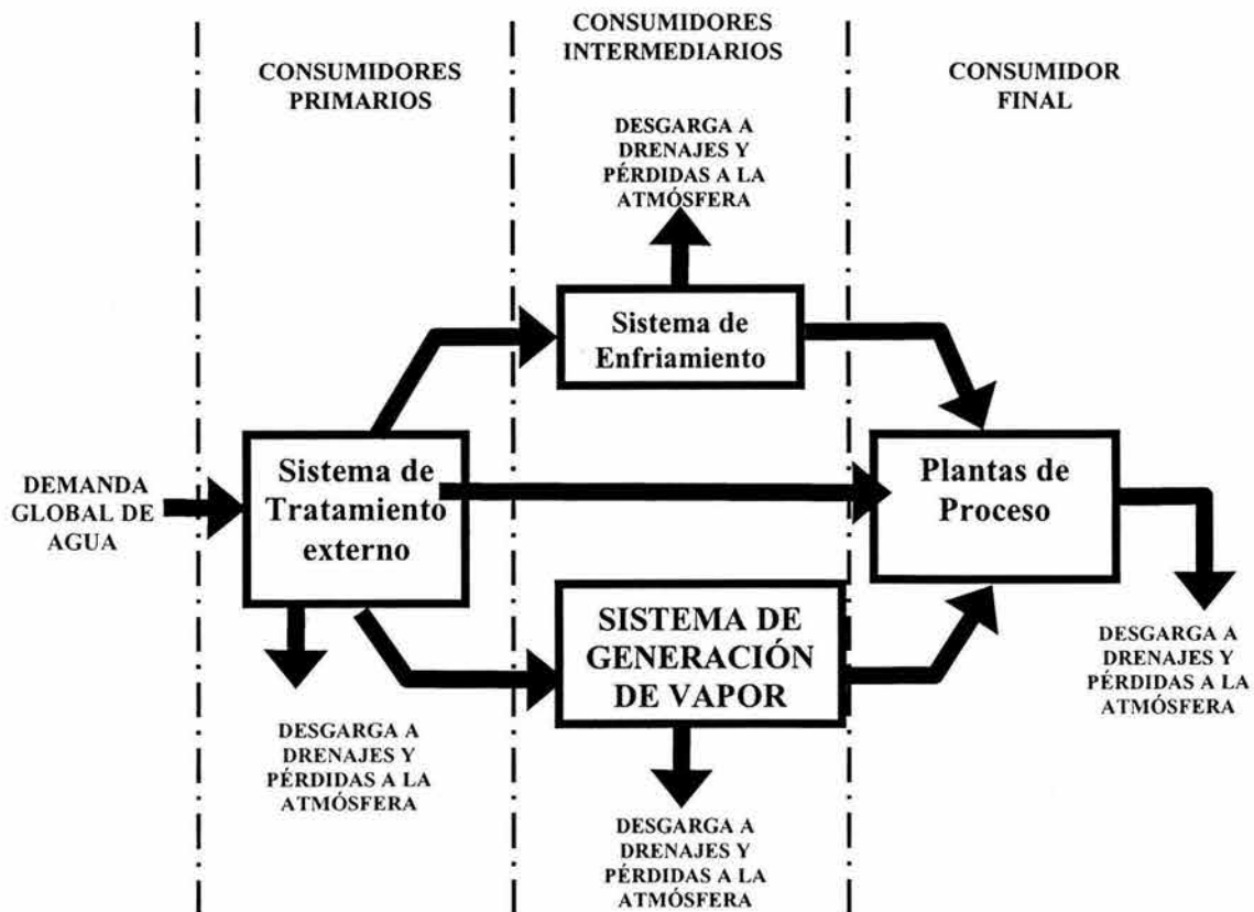
Diagrama 1. Distribución de agua en una planta química
