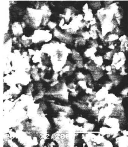
Figura 4.4.2 Micrografía de barrido de TiO 2 -Sn (90-10%) a 800 °C
