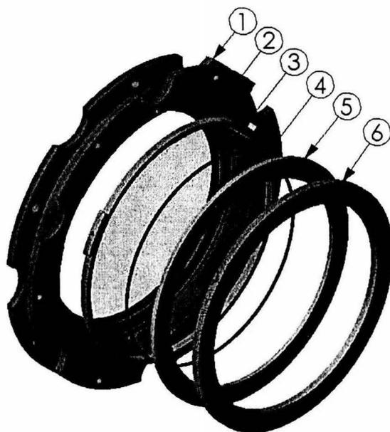
**Figura V.6** (1) Celda 2 de B2, (2) soporte radial, (3) lente, (4) O-ring y (5 y 6) separadores de S1.
