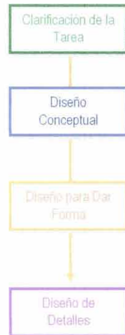
Figura 30. Modelo del proceso de diseño de Pahl y Beitz (Tomado de Cross 1999).
