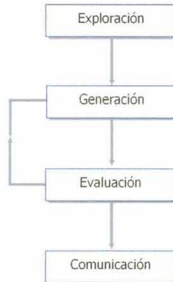
Figura 27. Esquema básico del proceso de diseño según Cross (1999)
