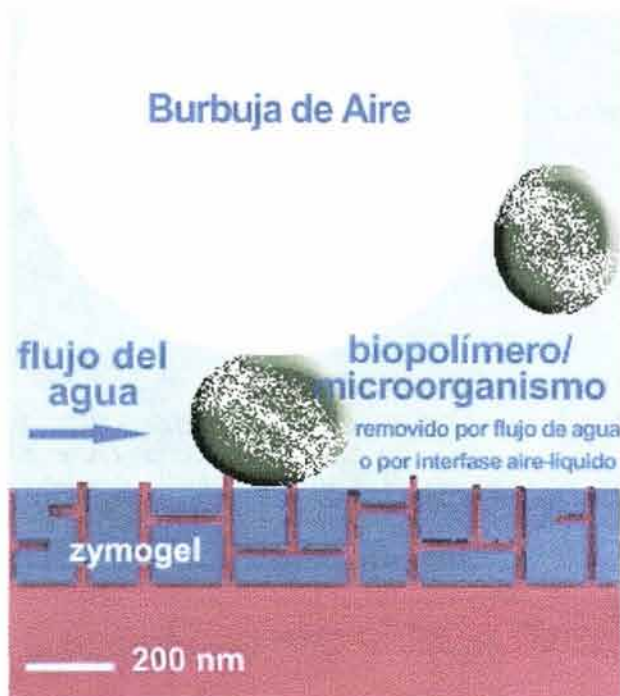
Figura 23. Modelo preliminar de las habilidades de autolimpieza de la piel del calderón de aletas largas ( Globicephala melas ), basado en el relieve de nanorugosidades rellenas de gel. Grandes biocontaminantes presentes en la capa laminar contigua a la piel son excluidos de la superficie por el relieve y pueden ser desechados por un flujo turbulento de agua o son removidas por fuerzas removedoras de una interfase aire-líquido durante los intervalos de respiración o durante los saltos del delfín. Las moléculas adhesivas más pequeñas son excluidas de la superficie por las propiedades del gel.
