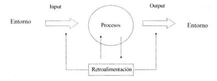
La retroalimentación, en el esquema anterior, representa el subsistema de control, siendo éste el que se encarga de brindar la información necesaria al sistema para permitirle realizar una comparación entre lo que se pretende lograr y lo que en realidad se está logrando,
