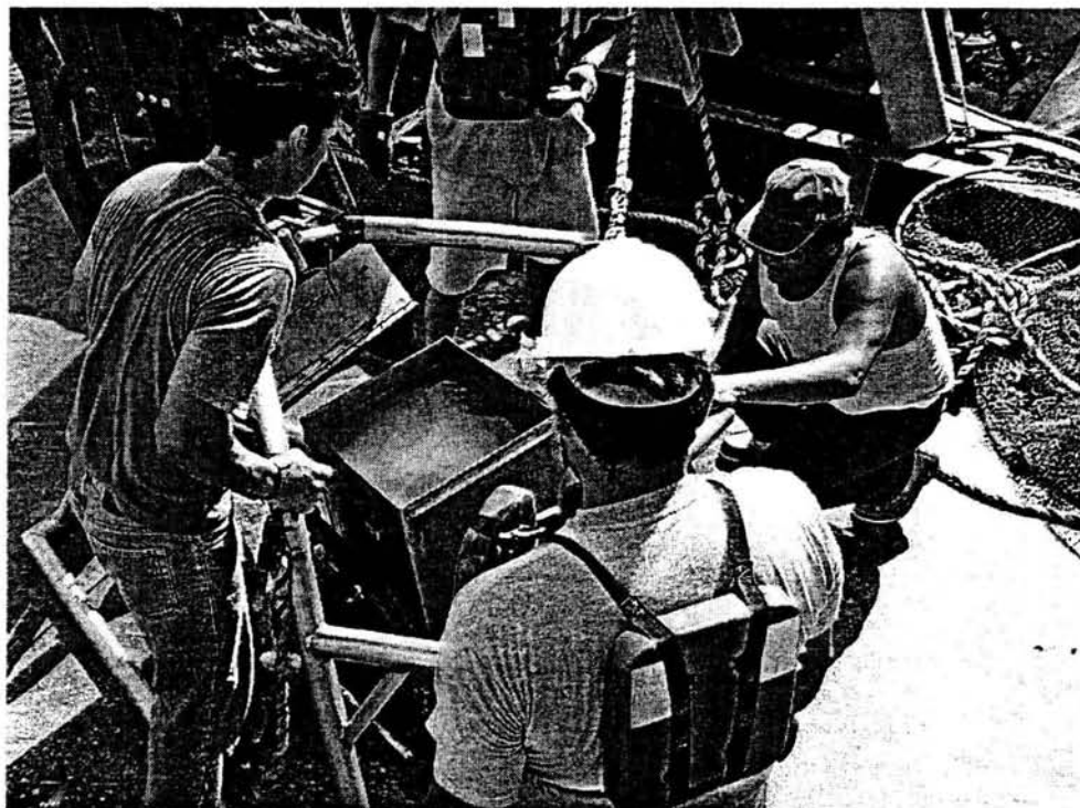
Toma de sedimento con el nucleador Reineck.
