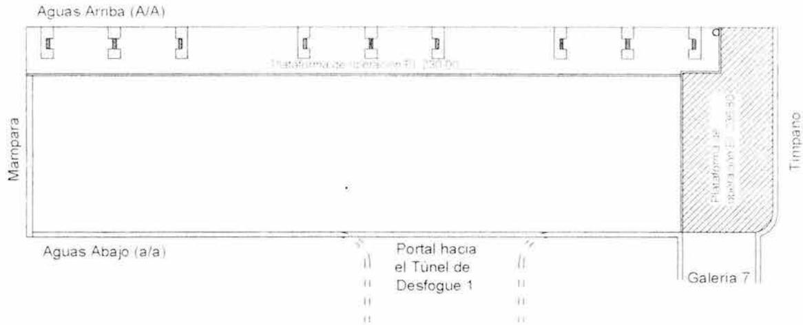
Fig. 5.3.3.- Ubicación del acceso a la Galería de Oscilación
