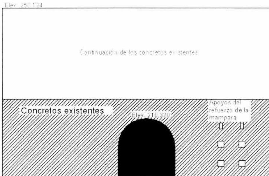
Fig. 5.3.6.- Forma de los colados en el muro aguas abajo (a/a).
