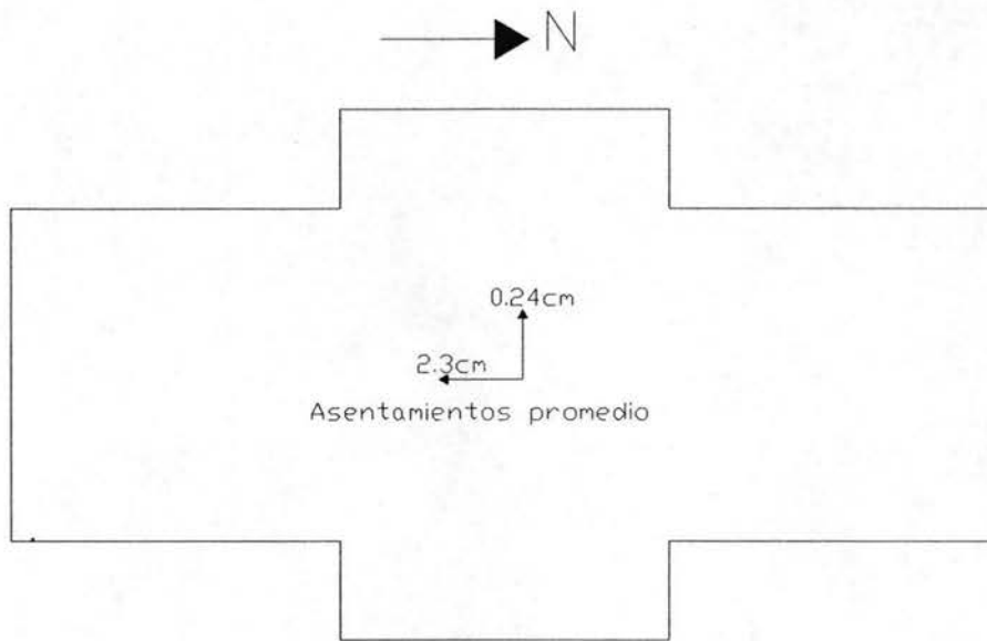
FIGURA 6.1. Planta tipo, se muestran los asentamientos promedio.
