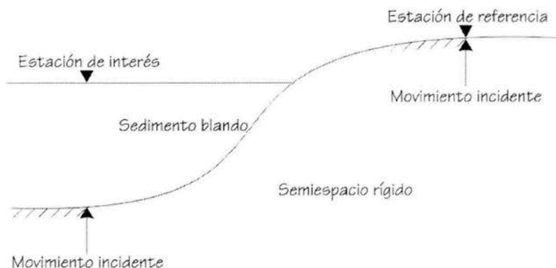
Figura 1.5. El método de cocientes espectrales asume que el movimiento incidente en una estación de referencia es representativo del movimiento incidente en la interfase roca-sedimento de la estación de interés.
