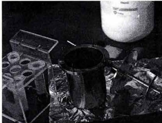
**Figura 4.2.2-1** Preparación de pastas de almidón en tanque de acero inoxidable (0.6 L de capacidad).
