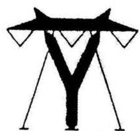
CIRCUITO UNICO CON CADENAS EN "V"
