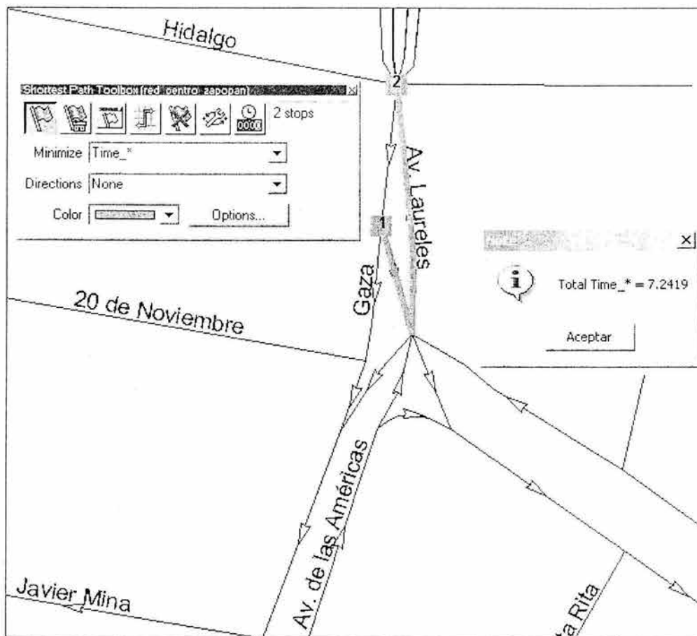
Figura 4.15. Al inicio, la red no tiene ninguna restricción de vuelta; observe que la vuelta en "U" sobre Av. Laureles es permitida. En la realidad esta vuelta no se permite.
