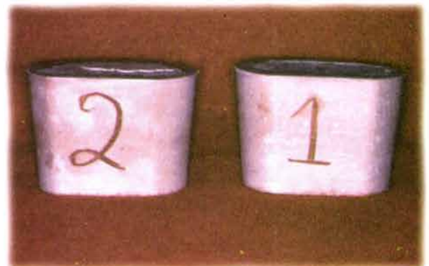
Fig. 5.3. Una vez que el revestimiento ha fraguado se recuperan los cilindros. Para conocer la cantidad de metal que se utilizará para cada colado, se sugiere numerar los cilindros.
