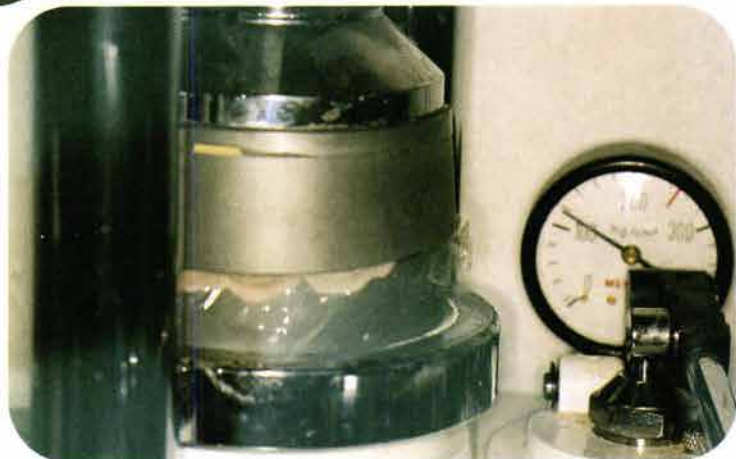
Fig. 6.18. Las muflas se cierran y se colocan en una prensa hidráulica, a la cual se le aplica lentamente presión para lograr el empaquetamiento total del acrílico.
