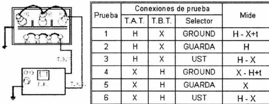
Fig. 2.16 Conexiones para la prueba de Factor de Potencia 6
