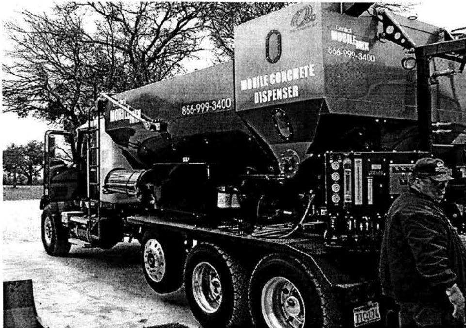
Fotografía III.6.- Vista lateral de un mezclador volumétrico, nótese que el equipo ésta montado en un camión. Del lado derecho se observa el operador de la unidad el cual también es quien maneja el tablero de control que se encuentra en la parte trasera de la unidad.
