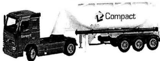
Figura IV.1.- Transporte especial para cemento a granel y abastecedor del silo.
