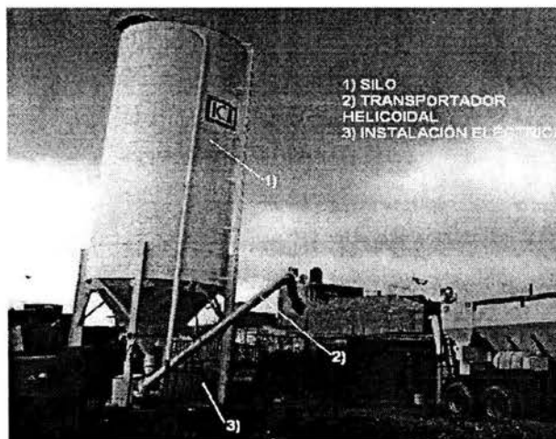
Fotografía IV.6.- Se muestran las partes de un silo de forma cilíndrica.
