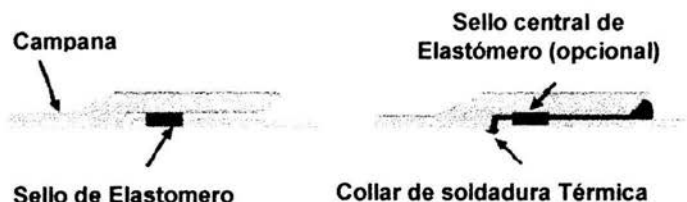
Figura 11.- Acoplamiento de campana y espiga con y sin soldadura térmica
