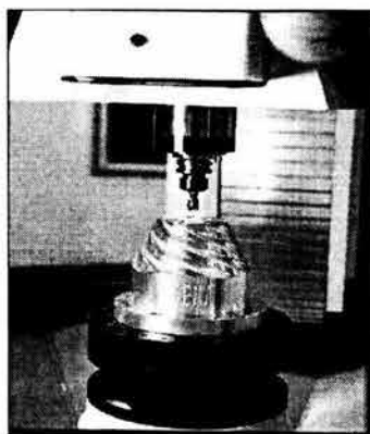
Figura I.39 Proceso de maquinado de alta velocidad de un robot eclipse.
