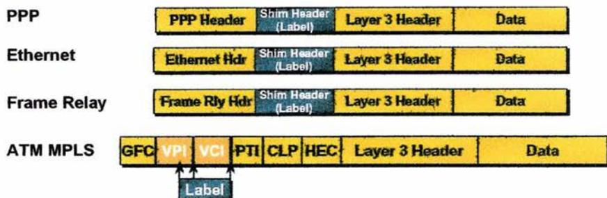
Figura 3.3. Ejemplos de encapsulación del “shim header” ó MPLS label en diferentes tipos de transporte.
