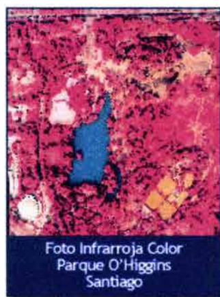
Fig. 2.12 Fotografía aérea con emulsión en infrarrojo de falso color Fuente: Servicio Aerofotogramétrico, Fuerza Aérea de Chile (2004)
