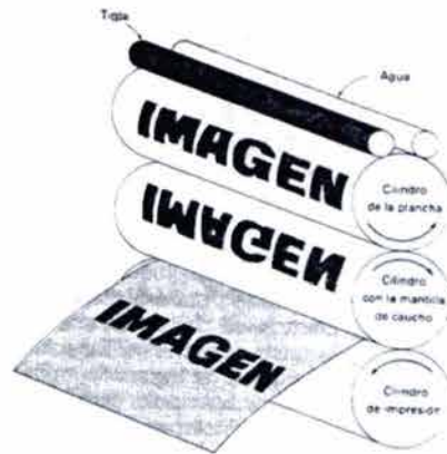
Fig. 5.8 Esquema de la reproducción por medio de la litografía Fuente: Arthur Robinson (et. al)Elementos de Cartografía. Pág. 465
