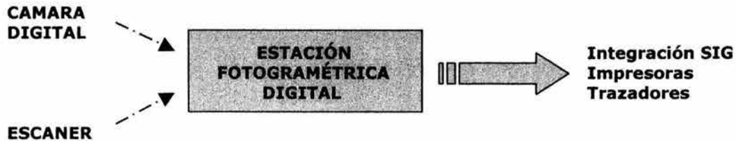
Fig. 4.46 Proceso de las fotografías digitales
