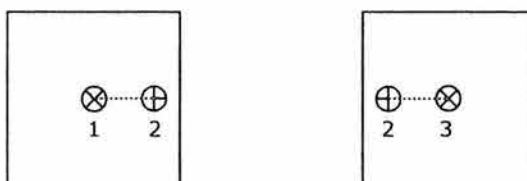
Fig. 4.29 Medición de dos fotografías con un punto principal transferido en común para la obtención de la altitud.
