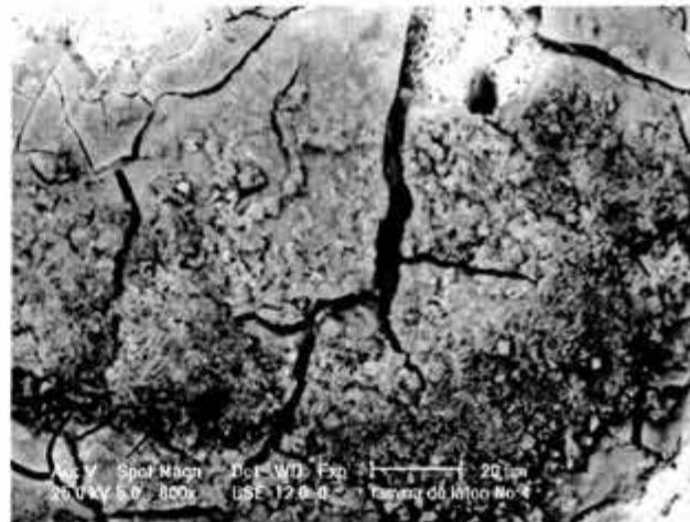
Figura 6.14. Con mayores ampliaciones se constata que la formación del depósito se efectúa en dos etapas, caracterizándose la primera capa por su menor porosidad. Sin embargo, el cambio de volumen con respecto al material original da como consecuencia su fractura.
