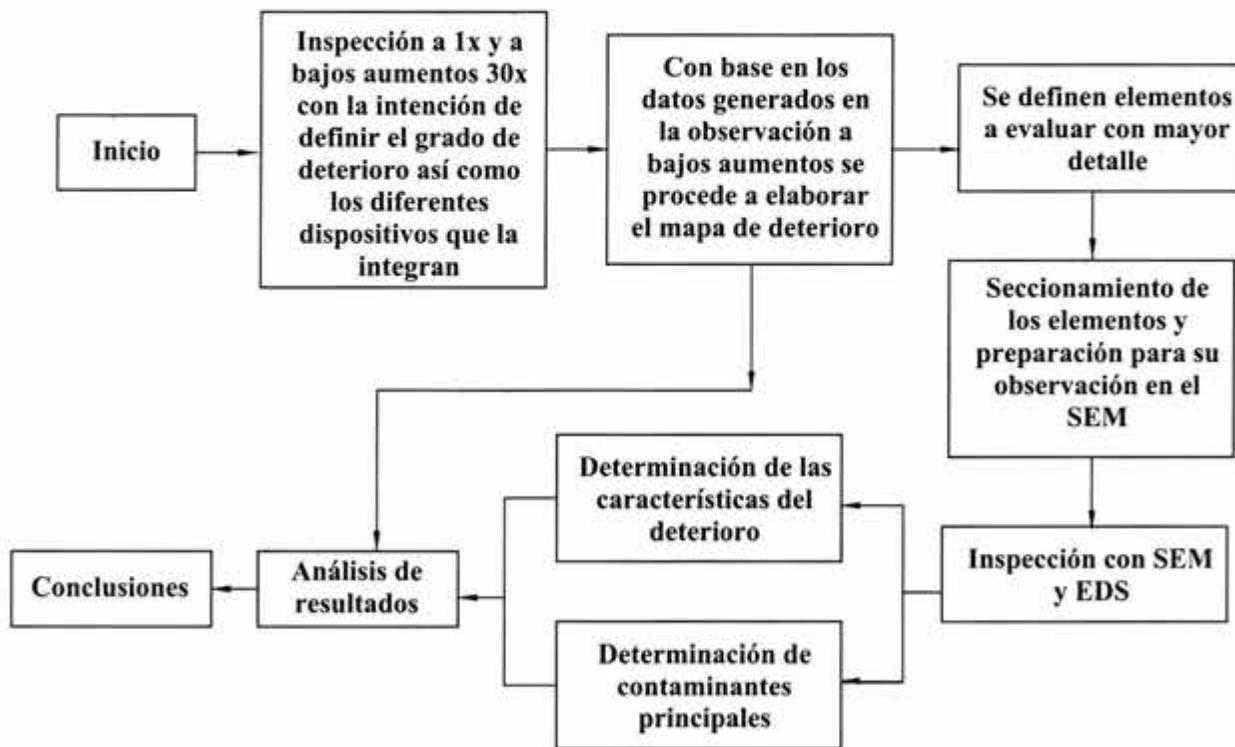
Figura 4.7. Metodología de estudio de las tarjetas electrónicas provenientes de equipo telefónico de uso residencial
