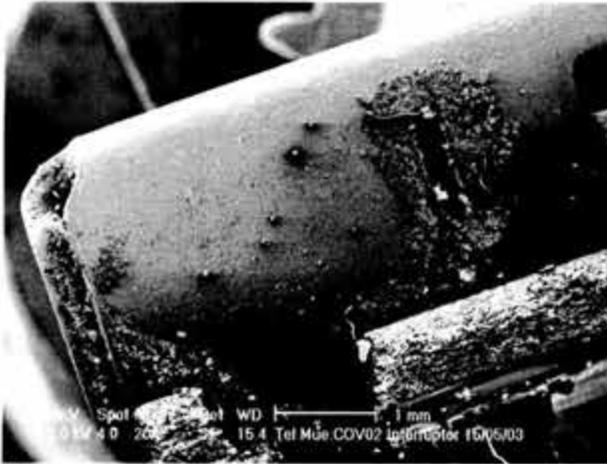
Figura 4.24a. Imagen a bajos aumentos (20x) de la carcasa del interruptor. Se trata de acero de bajo carbono niquelado, lo cual se confirma a través del análisis presentado en la tabla 4.8a
