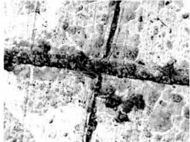
Figura 6.12. Los depósitos se caracterizan por ser usualmente porosos
