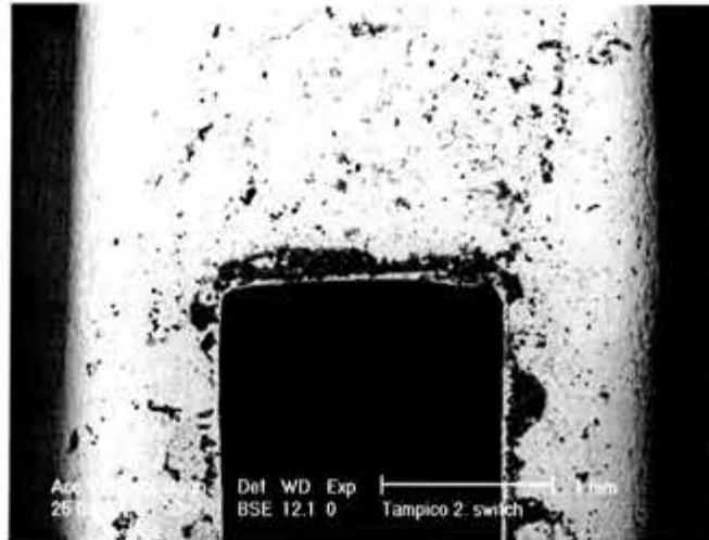
Figura 4.10 Carcaza de interruptor, es evidente la existencia de depósitos provocados cuando el electrolito se acumula en la zona troquelada, dando lugar a la presencia de un par galvánico
