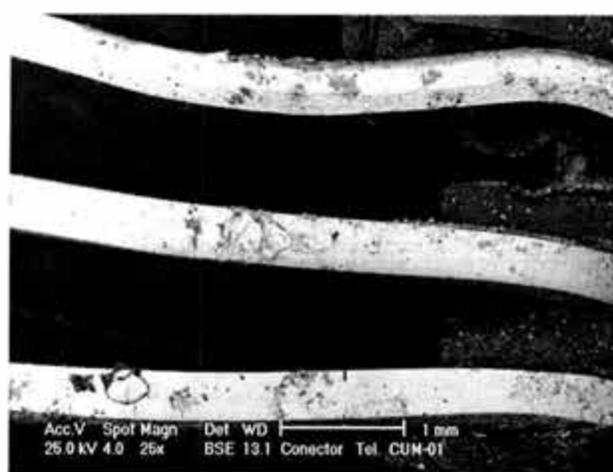
Figura 4.34a. Conector de cobre recubierto de oro. El deterioro del recubrimiento es muy fuerte, de tal forma que existe un notable desprendimiento del mismo
