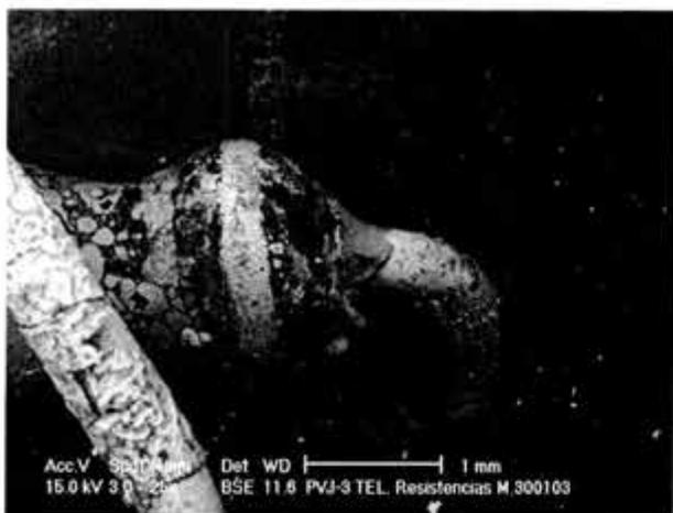
Figura 4.31a Conector de una resistencia. Se trata de un conductor de cobre recubierto con estaño. Los contaminantes presentes (cloruros) en combinación con una elevada humedad relativa dan como consecuencia un rápido deterioro del recubrimiento y su desprendimiento del conductor.
