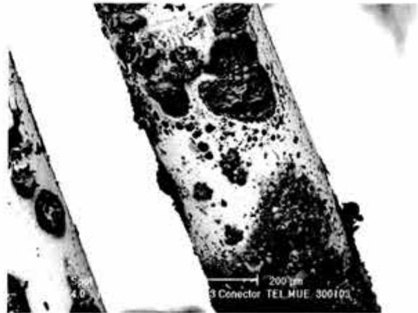
Figura 4.28b. El deterioro es muy intenso sobre todo en la zona de ensamble (parte inferior de la figura 4.28a)
