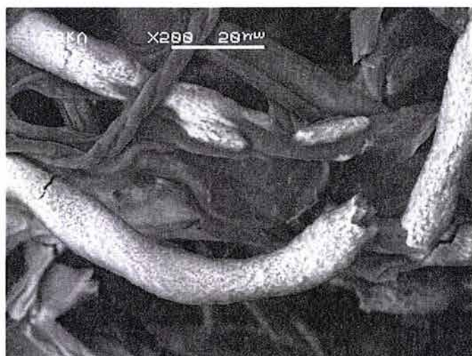
Figura 4.2.5. (a) Micrografías SEM del algodón modificado CMC-2A a 12 días de inmersión en una solución de cloruro de sodio, cloruro de potasio y fosfato de potasio a 60°C. (b) mayor ampliación
