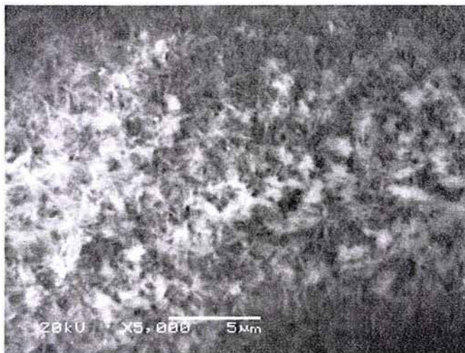
Figura 4.2.6. Micrografía SEM del algodón modificado CMC-2A a 12 días de inmersión en una solución de cloruro de sodio, cloruro de potasio y fosfato de potasio a 60°C.
