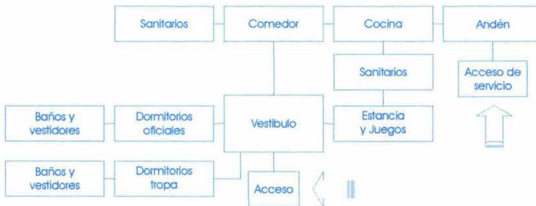
FIGURA 7.9-B DIAGRAMA DE FUNCIONAMIENTO DE LAS ÁREAS COMUNES
