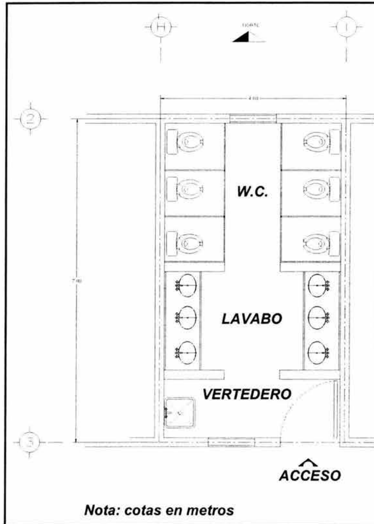
Figura 8.8 Planta arquitectónica para Sanitarios Femeninos.
