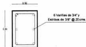
Columna de Concreto Armado f'c= 250 kgs/cm 2
