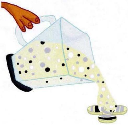
Una vez que se tiene la mezcla correspondiente, se vacía en moldes para que los elementos se sequen y se compacten. De esta manera se le da el tamaño y la forma requerida a la pastilla química.
