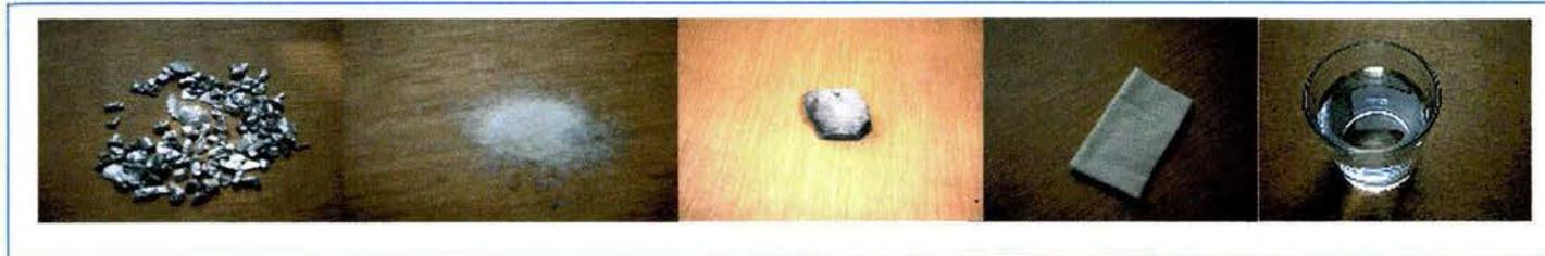
COMO PRIMER PASO, SE HIZO LA RELACIÓN EN PROPORCIÓN ENTRE EL MAGNESIO, EL CARBÓN ACTIVADO Y EL ÁCIDO TARTÁRICO, PARA OBTENER LA FÓRMULA EN LA QUE EL MATERIAL, AL REACCIONAR CON EL AGUA ALCANZA LOS 90°C.
