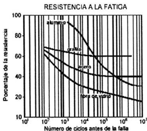
Figura 6.14 Comparación entre resistencias a la fatiga de fibras de carbón ( grafito ), acero, fibra de vidrio y aluminio.
