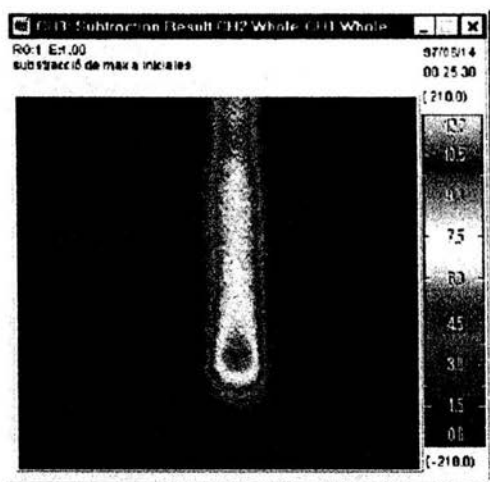
Figura 5.18 Termografía de rayos infrarrojos de una barra de refuerzo a tensión.
