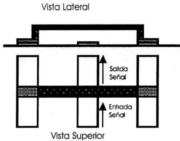
Fig. 5.3.2.- Interruptor perpendicular a la línea de transmisión de la señal con membrana
