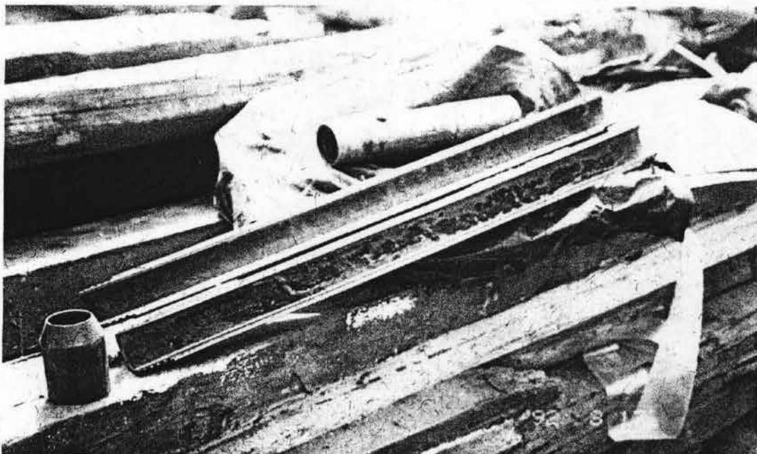
SE OBSERVA EL TUBO PARTIDO UTILIZADO PARA LA OBTENCION DE MUESTRAS ALTERADAS DURANTE EL PROCESO DE HINCADO DE LA TUBERIA DE PERFORACION
