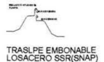
DETALLE DE TRASLAPE PARA LOSACERO
